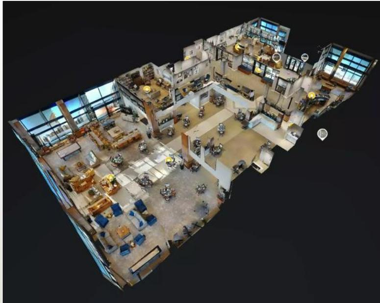
**Nous cartographions l'environnement en collectant les données visuelles et spatiales à l'aide d'un scanner laser de 134 mégapixels doté d'un GPS.**
